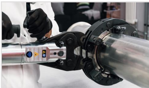
Assemblaggio pressatura n°1 / Press assembly phase 1
