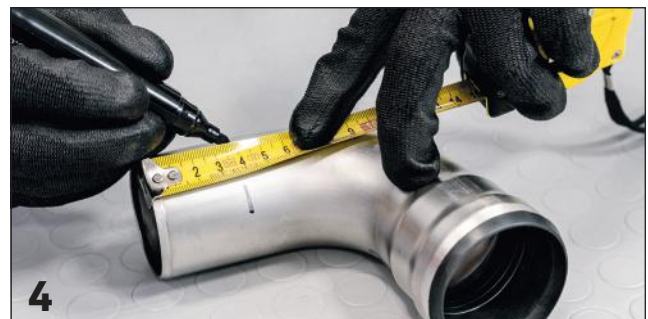
4 Marcatura quota d'innesto / Marking the insertion's depth
