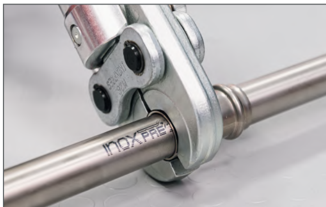
Assemblaggio attraverso pressatura / Making the press connection
